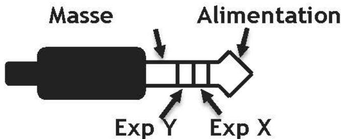
Les pédales d'expression tierces peuvent également être utilisées à condition qu'elles disposent d'une fiche TRS (Tip Ring Sleeve) avec l'alimentation sur la pointe, l'expression (le curseur du potentiomètre) sur l'anneau et la masse sur la gaine comme indiqué sur le schéma suivant.
