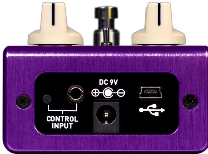
CONTROL INPUT 포트는 다양한 외장 컨트롤 옵션을 제공해 스펙트럼 인텔리전트 필터의 다양한 파라미터 값을 바로 제어할 수 있게 합니다. 소스 오디오 탭 스위치, 소스 오디오 듀얼 익스프레션 페달 또는 뉴로 허브 데이터 포트를 연결할 수 있습니다.
