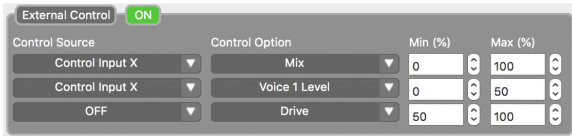
외장 컨트롤 블록(External Control Block)은 소스 오디오 듀얼 익스프레션 페달, 핫 핸드 3 무선 컨트롤러, 뉴로 허브에 연결된 익스프레션 페달과 같은 외장 익스프레션 컨트롤을 설정하는 곳입니다. 모든 외장 컨트롤 익스프레션 기기는 1/8인치 TRRS 케이블을 이용해 페달의 윗면의 CONTROL INPUT 잭에 연결됩니다.
